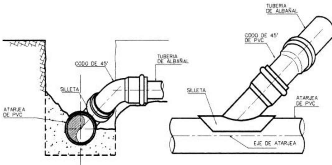
**FIGURA Nº 2-15.- DESCARGA DOMICILIARIA CON TUBERÍA DE PVC**
