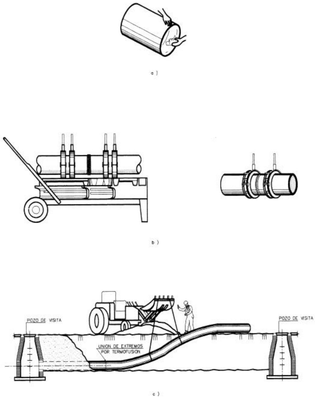
**FIGURA Nº 8-8.- INSTALACIÓN DE TUBERÍA DE POLIETILENO**
