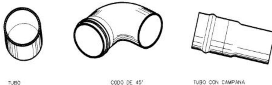
**FIGURA N° 2-10.- TUBERÍA Y PIEZAS ESPECIALES DE PVC DE PARED ESTRUCTURADA**
