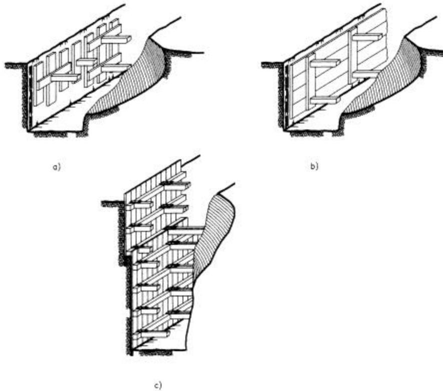
**FIGURA N° 8-3.- SISTEMAS DE PROTECCIÓN DE ZANJAS**
