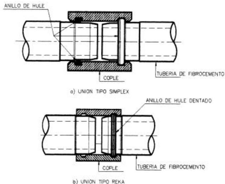
**FIGURA Nº 2-9.- TIPOS DE UNIONES EN TUBERÍAS DE FIBROCEMENTO**
