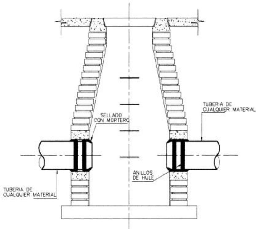
**FIGURA N° 2-17.- CONEXIÓN HERMÉTICA DE POZO DE VISITA CON TUBERÍA**
