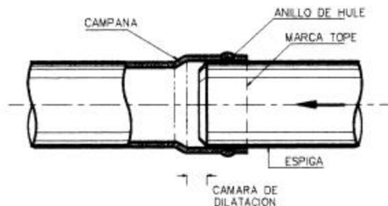
**FIGURA N° 2-11.- UNION CAMPANA-ESPIGA EN TUBERÍA DE PVC**
