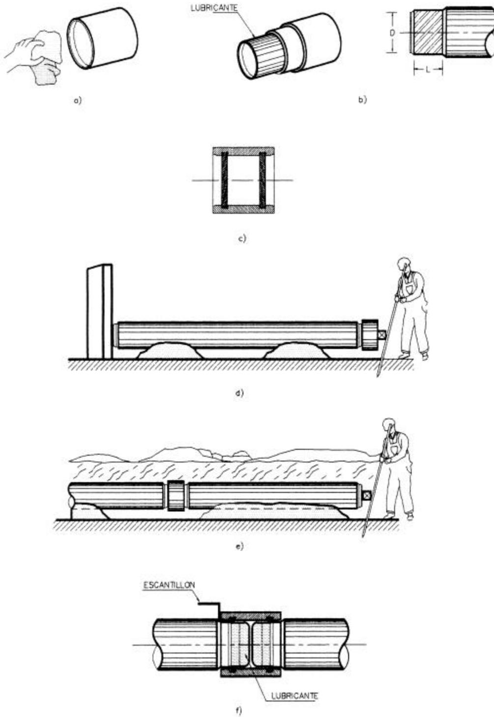
**FIGURA N° 8-6.- INSTALACIÓN DE TUBERÍA DE FIBROCEMENTO**
