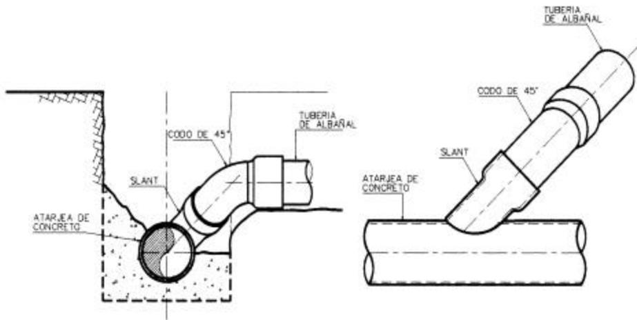
**FIGURA N° 2-13.- DESCARGA DOMICILIARIA CON TUBERÍA DE CONCRETO**
