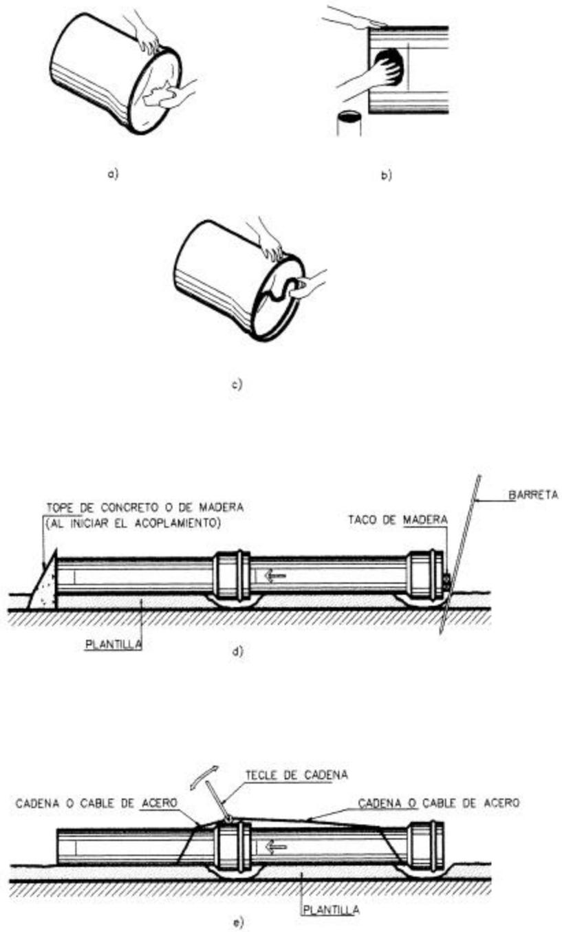
**FIGURA Nº 8-7.- INSTALACIÓN DE TUBERÍA DE PVC**
