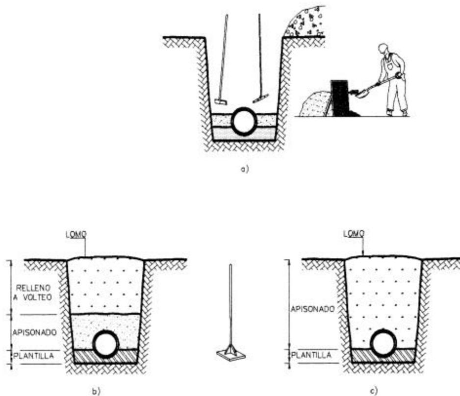
**FIGURA N° 8-9.- PROCEDIMIENTO DE RELLENO DE ZANJAS**
