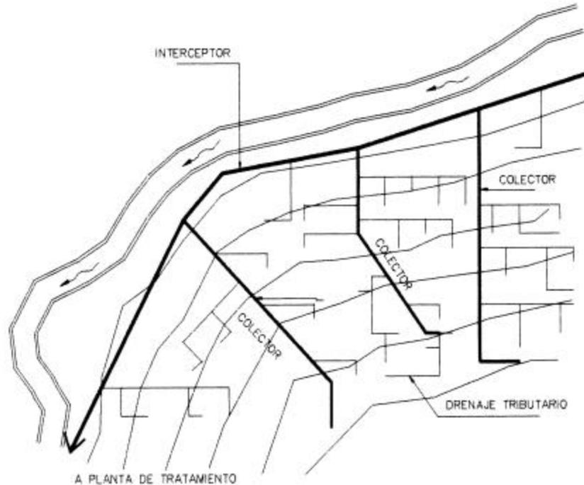
**FIGURA N° 2-4.- MODELO PERPENDICULAR**
