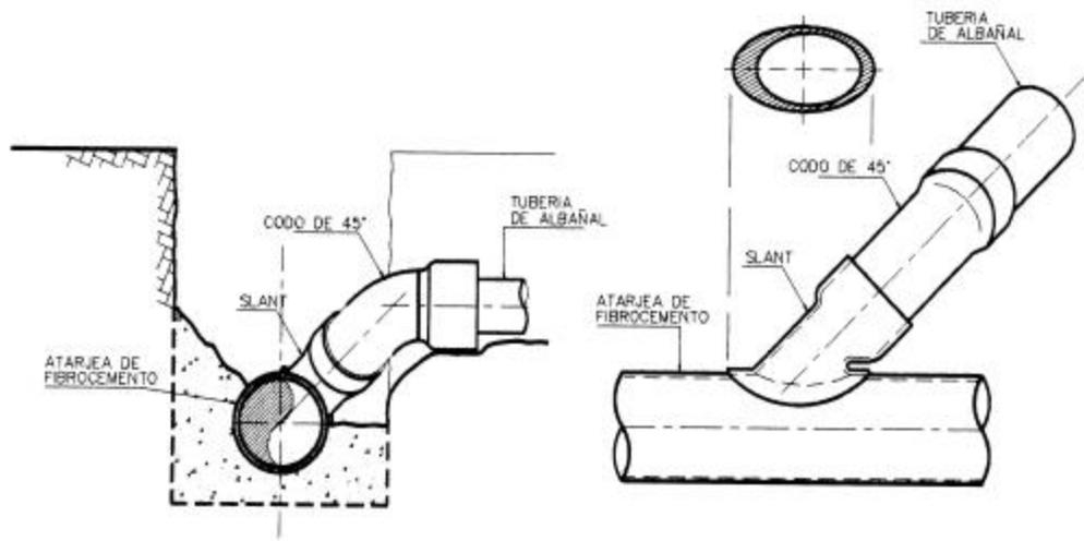
**FIGURA Nº 2-14.- DESCARGA DOMICILIARIA CON TUBERÍA DE FIBROCEMENTO**
