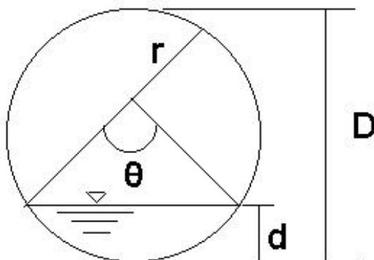
**FIGURA N° 3.2.- CARACTERÍSTICAS HIDRÁULICAS DE UNA TUBERÍA**
