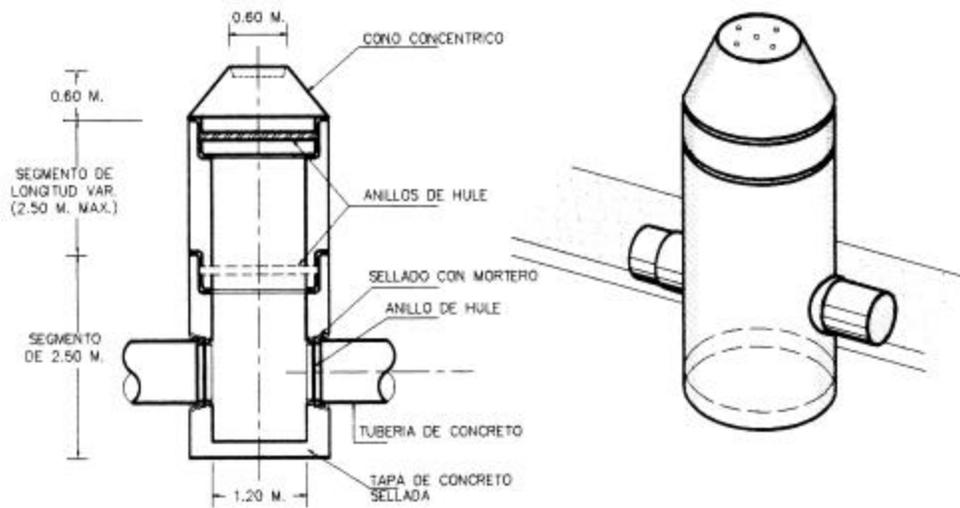
**FIGURA N° 2-19.- POZO DE VISITA DE CONCRETO PREFABRICADO**
