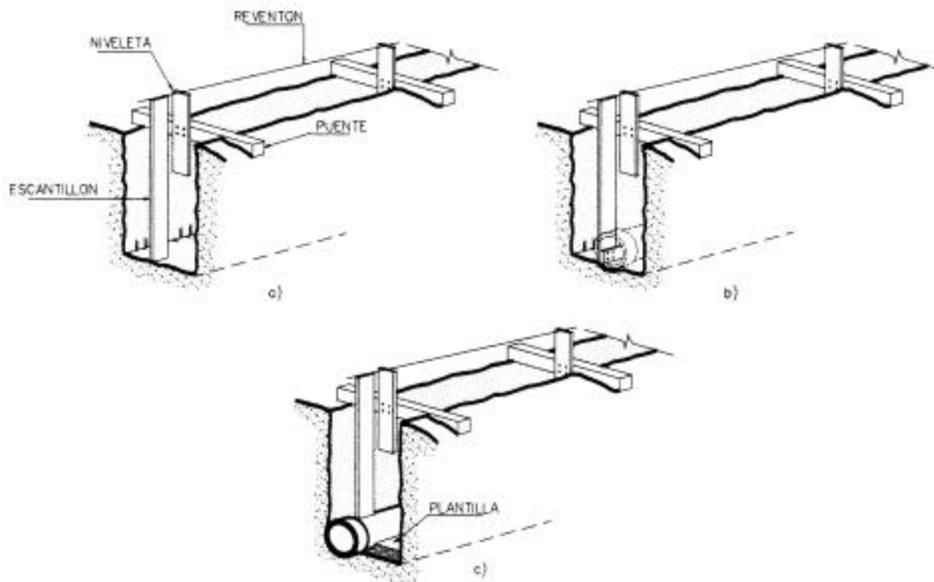
**FIGURA N° 8-2.- PROCEDIMIENTOS DE NIVELACIÓN EN ZANJA**
