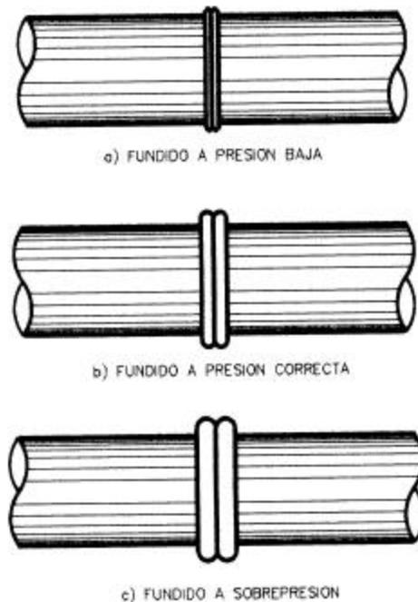
**FIGURA N° 2-12.- TIPOS DE UNIONES EN TUBERÍAS DE POLIETILENO**
