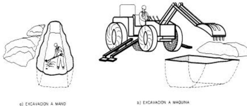
**FIGURA N° 8-1.- PROCEDIMIENTOS DE EXCAVACIÓN EN ZANJA**
