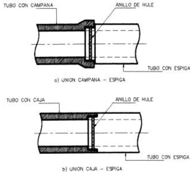
**FIGURA N° 2-8.- TIPOS DE UNIONES EN TUBERÍAS DE CONCRETO**
