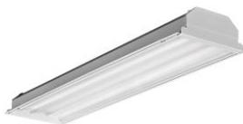
Luminario de sobreponer, con dimensiones de 121.90 cm de largo x 31.10 cm de ancho y 12.10 cm de altura, gabinete con marco abatible, fabricado en acero laminado en frío de una sola pieza, acabado con pintura poliéster en polvo aplicado electrostáticamente, difusor fabricado con polímero de alto peso molecular, integrado por 2 lámparas fluorescentes de 2 x 32W T8, voltaje de 120-277V, balastro electrónico de arranque instantáneo. Garantía limitada de 1 año.
