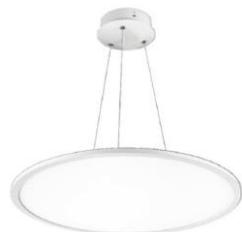
Luminario de suspender, carcaza de aluminio, color blanco, pantalla PMMA, sin bases, lámpara LED integrada, tensión nominal de 100-240V, consumo de potencia de 36W, frecuencia nominal de 50/60 Hz, consumo de corriente de 0.36-0.15<sup>a</sup>, factor de potencia de 0.9, flujo luminoso de 2200 lm, temperatura de color de 4000K, luz blanca fría, ángulo de apertura 120°, IRC 80, temperatura de operación de -20 - 45°C, 25,000 horas de vida, no atenuable, garantía de 3 años.
