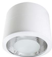
Luminario para interiores, con dimensiones de 22.0 cm de diámetro x 10.5 cm de altura, en color blanco, equipado con lámpara fluorescente, portalámpara G24q3, tensión nominal de 120 – 277V, consumo de potencia de 52 W, frecuencia nominal de 50/60 Hz, consumo de corriente de 0.043 – 0.18A, factor de potencia 0, flujo luminoso de 1400 lm, temperatura de color de 4100K, IRC 80, temperatura de operación de 0 a 40°C, 10,000 horas de vida, no atenuable. Garantía de 1 año.
