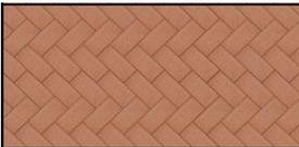
Adoquin de barro 100% natural extruido con dimensiones de 6.00 cm x 10.00 cm x 20.00 cm, con tolerancia dimensional de +- 3 mm, 50 piezas x m2, con un peso nominal de 2.46 kg por pieza, resistencia a compresión promedio de 350 kg/cm2, 14.70% absorción de agua con respecto al peso, romendado para transito ligero.
