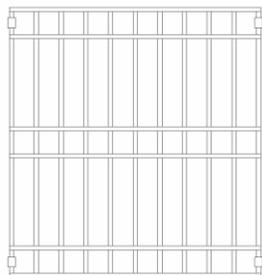
Protección para ventanas fabricada con varilla redonda lisa galvanizada con pintura poliéster termoendurecido, electro-soldado uniforme en puntos de cruce, acabado limpio y de alta resistencia, resistencia a la ruptura de la varilla de 75,000 - 100,000 lb/plg<sup>2</sup>, diámetro de varilla de 3/8", capa de zinc de 90 gr/m<sup>2</sup> como mínimo. Dimensiones de 1.20 x 1.20 m, 1.50 x 1.50 m, 1.50 x 1.20 m, 1.20 x 1.00 m, 1.20 x 1.50 m, 1.00 x 1.00 m, 0.60 x 0.60 m, 0.60 x 0.40 y 0.40 x 0.40 m.
