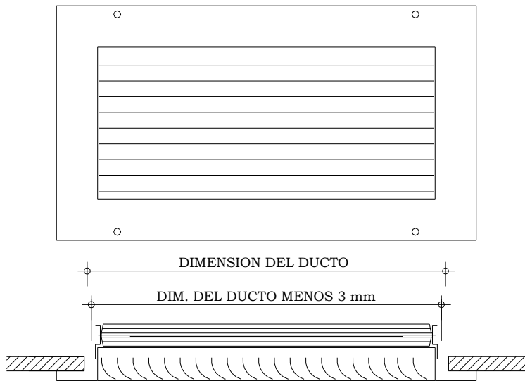
Figura 44.14 Detalle de instalación de rejilla.
