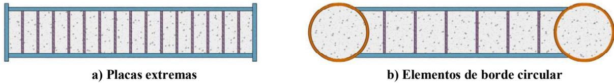
Figura 22.18.2.a - Muros de cortante planos en sección compuesta
