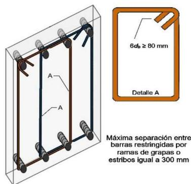
Figura C8.3.4 – Ejemplo de estribos sobrepuestos en una viga
