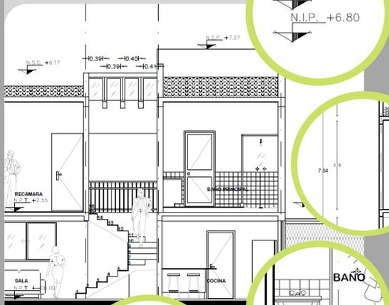
Cotas de entrepisos: alturas libres, de ventanas, antepechos; dibujo de espesores de losas, muros y dimensiones reales de cadenas/traves
