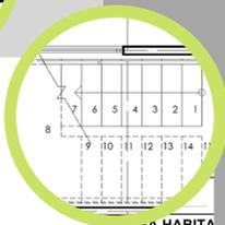
Línea y flecha de corte para indicar las diferentes secciones/alzados
