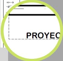
Proyecciones de losa con línea punteada (losas por encima del plano de corte)
